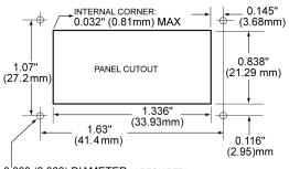
0.093 (2.362) **DIAMETER** (4 REQUIRED) ONLY WHEN USING BEZEL ASSEMBLY
